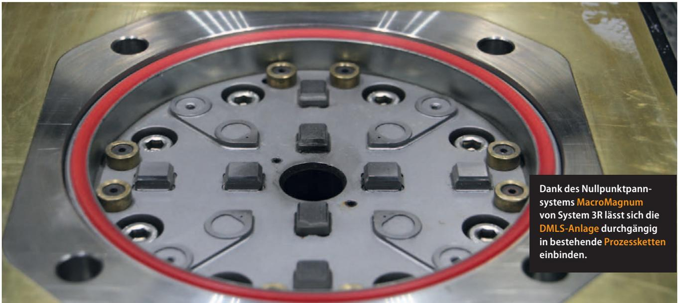
Dank des Nullpunktspannsystems **MacroMagnum** von System 3R lässt sich die **DMLS-Anlage** durchgängig in bestehende **Prozessketten** einbinden.
