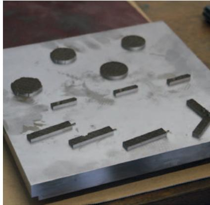
Die Palette lässt sich schnell wechseln – hier noch die Stützstrukturen verschiedener Bauteile.
